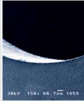
精确切割敏感材料（氮化铝）
